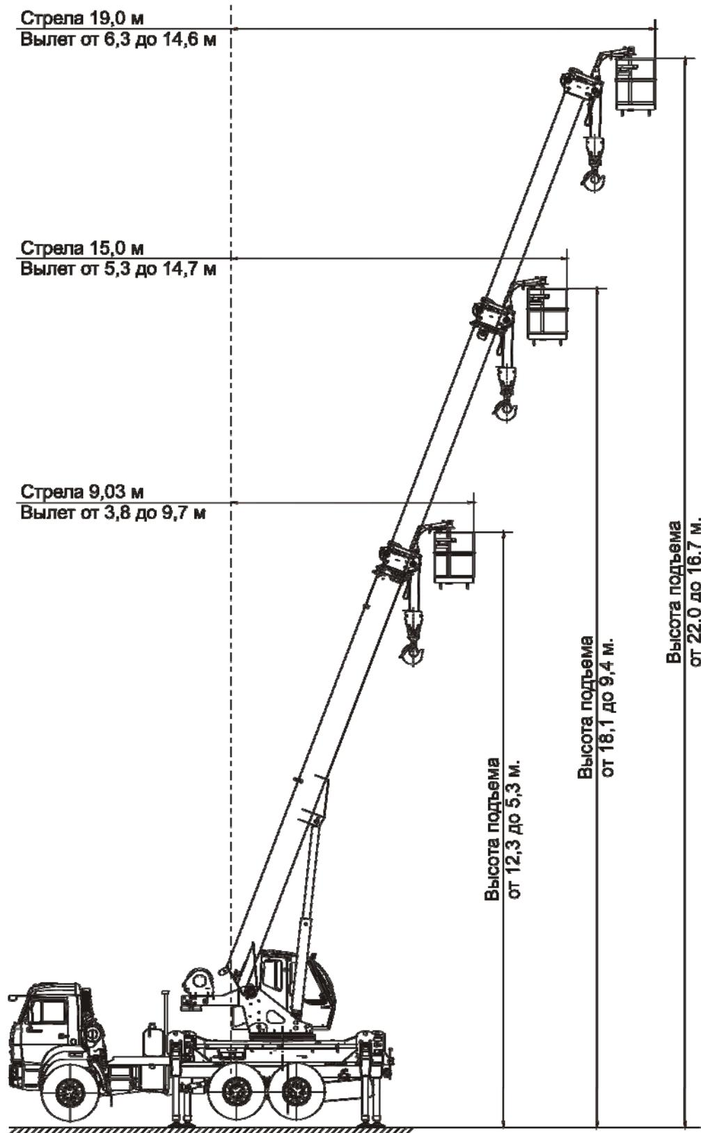
Общий вид в рабочем положении со сменным рабочим оборудованием
